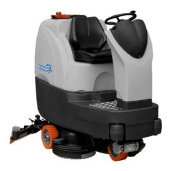
Die batteriebetriebene Aufsitzmaschine mit 2 Tellerbürsten und einer Arbeitsbreite von 90 cm reinigt mühelos Großflächen in Industrie und Gewerbe.
