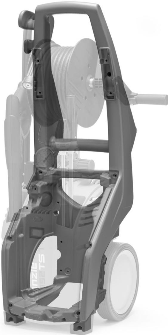
Zentrales Element des neu konzipierten Hochdruckreinigers K 1152 TS T ist der selbsttragende Rahmen, der in der Produktion im Werk 2 in Illertissen/Bayern nach dem Rotationsinterverfahren als durchgängiges Rotationsformteil hergestellt wird. Dieser äußerst feste und verwindungssteife Rahmen (Roto-Mold-Fahrgestell) sorgt für eine Maximierung der Stabilität des Hochdruckreinigers. Motor und Pumpe liegen gut geschützt im Rahmen und sind damit vor Einwirkungen von außen weitgehend abgeschirmt.
