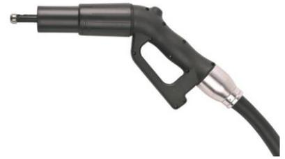
Der speziell entwickelte Sensorkopf verhindert ein Überlaufen des Tanks. Die adaptive Füllgeschwindigkeit variiert je nach Tank zwischen 2,5 - 8l/min. Durch diese intelligente Volumenstromregelung wird eine einzigartige Kombination aus schneller und sicherer Befüllung erreicht.
