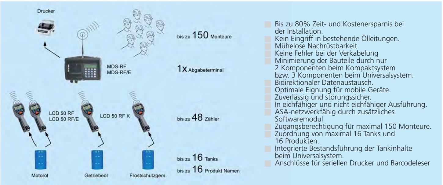
Das Kompaktsystem besteht aus einem Abgabeterminal mit integriertem Drucker MDS-RF, nicht eichfähig oder MDS-RF/E, eichfähig und bis zu 48 Abgabezählern LCD 50 RF oder LCD 50 RF K, beide nicht eichfähig bzw. LCD 50 RF/E eichfähig.
